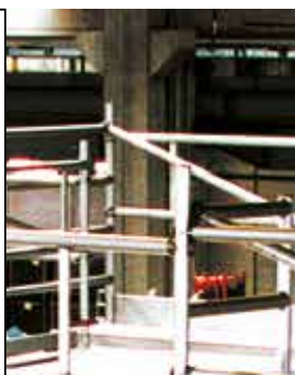
Ponteggio per piani di coda BOEING 737
